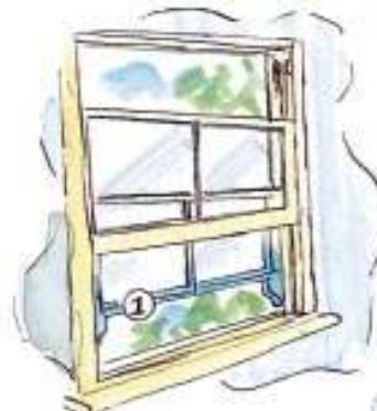
**1 Поднимите нижнюю часть рамы и опустите верхнюю. Покрасьте нижнюю планку верхней части рамы и видимые части вертикальных переплетов.**
