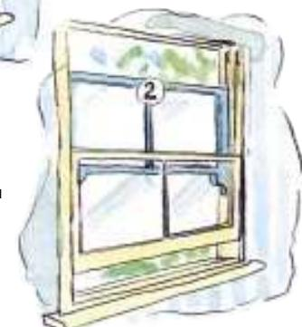
**2 Поменяйте положение рамы, оставляя зазор снизу и сверху, и покрасьте верхнюю часть рамы.**
