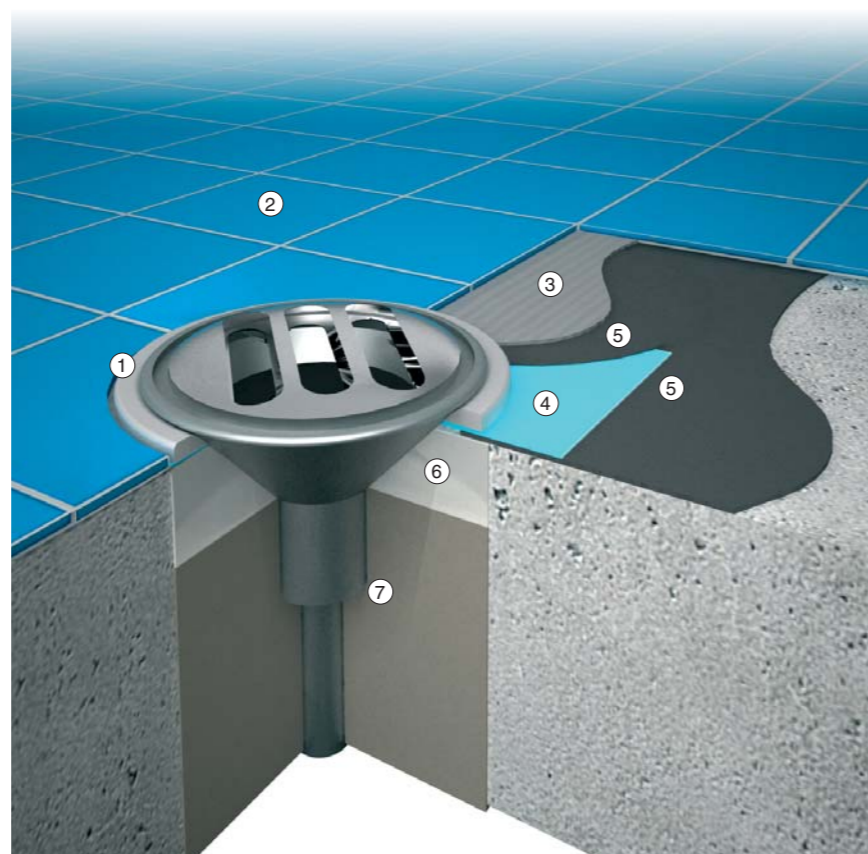
Устройство закладной на дне бассейна
