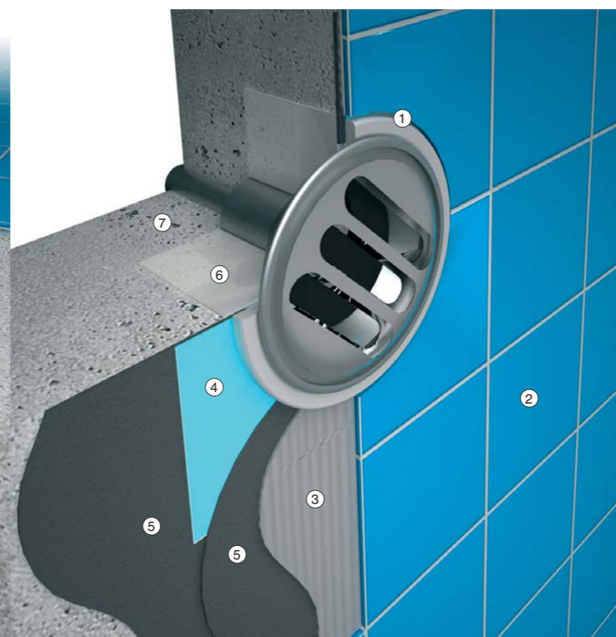
Устройство закладной в стене бассейна
