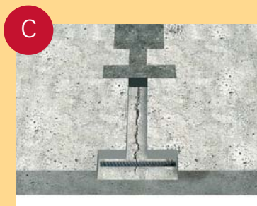
Узел С. Устранение течи и сшивка трещины с помощью арматурных стержней с целью предотвращения ее повторного раскрытия
